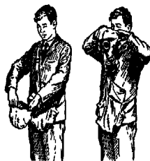
Рис 3.3. Надевание противогаза ГП-5
